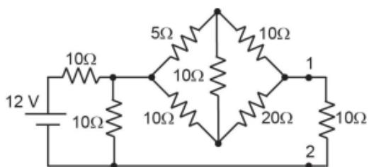
Deseja-se substituir o circuito visto a partir dos terminais 1–2 pelo seu equivalente de Thévenin. Nessas condições, determine o valor da tensão de Thévenin ( $V_{Th}$ ), em volts, entre os terminais 1 e 2.
