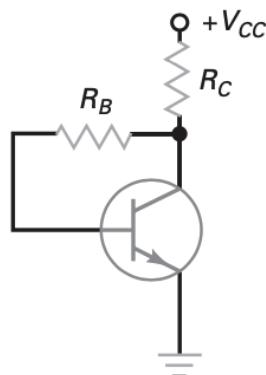
Considerando que  $V_{CC}$  seja 12 V, a corrente de coletor  $I_C$  seja 2 mA,  $R_C$  seja  $650 \Omega$  e  $\beta$  igual a 100, qual é o valor do resistor  $R_B$ ?
