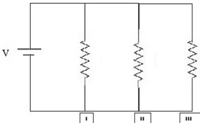
Considere que os resistores são  $R_1 = 6\Omega$ ;  $R_2 = 3\Omega$ ;  $R_3 = 2\Omega$ .
