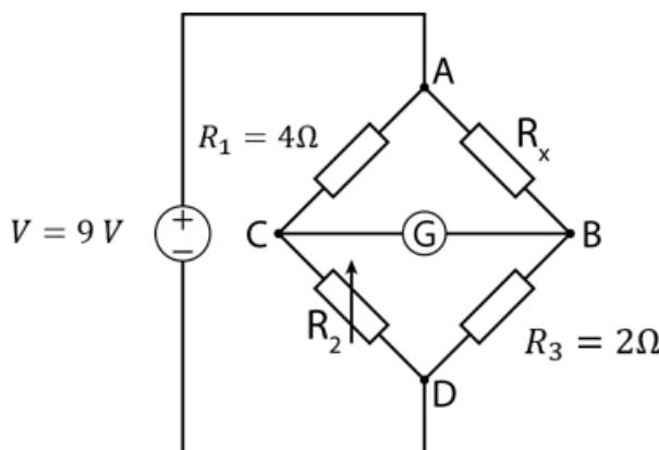
Ajustando-se o potenciômetro  $R_2$  para  $8\Omega$ , a corrente e a tensão medidas pelo galvanômetro tornam-se nulas. Nesta situação, o valor da tensão entre os pontos A e B, em volts, equivale a
