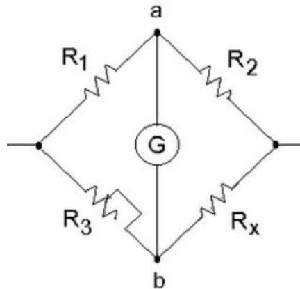
Considerando que o circuito está equilibrado e galvanômetro medindo 0. Sendo  $R_1$  e  $R_2$ , respectivamente,  $100\Omega$  e  $200\Omega$ , enquanto  $R_3$  e  $R_x$  têm, respectivamente,  $150\Omega$  e  $x\Omega$ . Se  $R_3$  for reduzido à metade, qual deverá ser o novo valor de  $R_x$  para que a ponte continue equilibrada?
