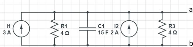
Considerando-se os terminais a-b, nessas condições, a potência dissipada em uma carga de 8 ohms equivale a
