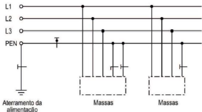
**43.** Considere o esquema de aterramento de uma instalação, mostrado na figura a acima, adaptado da Norma da ABNT NBR 5410:2004. O esquema de aterramento apresentado na figura é denominado
