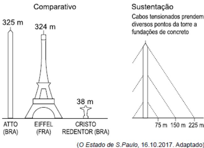
Considere a torre posicionada perpendicularmente ao solo e admita que o cabo tensionado fixado no solo a uma distância de 75 m da base da torre esteja preso à torre em um determinado ponto, cuja altura, em relação ao solo, seja igual a 100 m.
