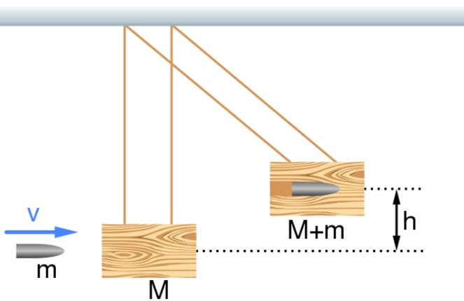
Na figura acima, temos o chamado pêndulo balístico, por meio do qual podemos calcular a velocidade com a qual um projétil é disparado em um bloco de madeira.
