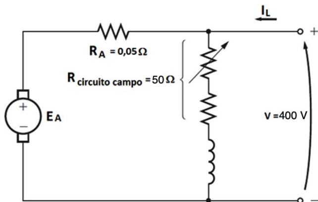
Este motor é de 400 V e seu circuito de campo possui resistência total de 50  $\Omega$ . A tensão EA para esta carga é de 390 V.
