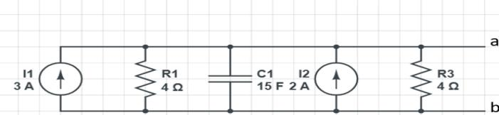
A máxima transferência de potência para uma carga conectada aos terminais a-b equivale a:
