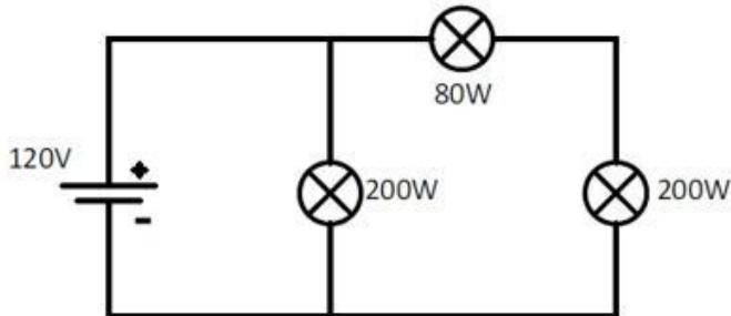
Qual o valor aproximado da resistência da lâmpada de 80W em  $\Omega$ ?
