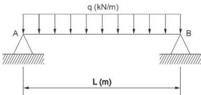
Para a viga biapoiada representada na figura acima, onde  $q$  e  $L$  são respectivamente iguais a  $2\text{kN/m}$  e  $0,5\text{m}$ , o momento fletor máximo é de  $62,5\text{ N.m}$
