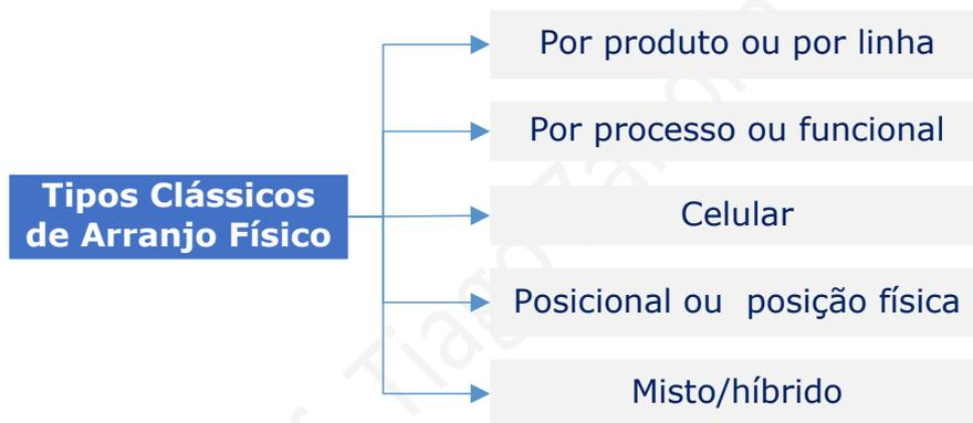
**Layout por produto/linha (flow)** - É também chamado de linha de produção ou linha de montagem. O layout em linha é aquele em que os equipamentos estão dispostos em uma sequência específica, sem caminhos alternativos, obedecendo a um fluxo de trabalho linear. Os equipamentos são agrupados de forma lógica de modo que as operações sejam executadas no produto.
