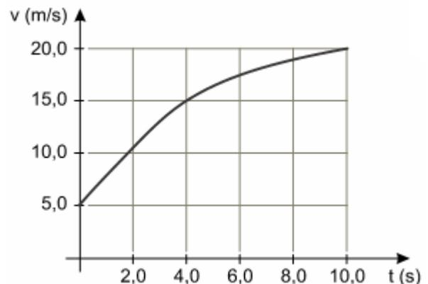
A intensidade média da força resultante sobre esse automóvel, no intervalo de tempo entre zero e quatro segundos, é de 3kN.
