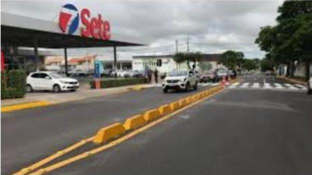
Como se pode ver, há na figura vários dispositivos em amarelo dispostos ao longo da via, chamados de prismas. Segundo estabelece o Anexo II do CTB, atualizado pela Resolução CONTRAN nº 160/04, os prismas pertencem à espécie de dispositivo auxiliar chamada de dispositivo de canalização, cuja função é a de substituir a guia da calçada (meio-fio) quando não for possível sua construção imediata. Eles podem ser também da cor branca, a depender da marca viária que complementem.
