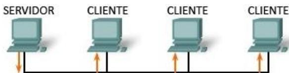
**90.** Considerando que uma rede local seja formada por 4 máquinas, a imagem acima meramente ilustra uma comunicação por rede *multicast*, onde os pacotes de dados são enviados de um host específico a todos os dispositivos clientes.
