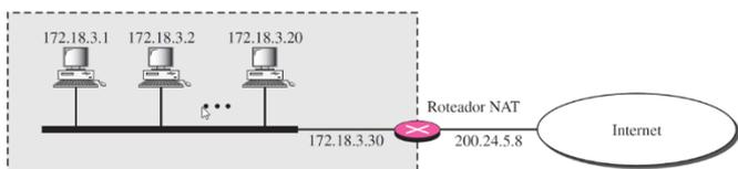
25. Na imagem apresentada, há três máquinas com endereços lógicos diferentes, no entanto todo pacote que sai dessa rede interna – independente da máquina remetente – terá como endereço de origem 200.24.5.8.
