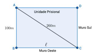
Vamos calcular o comprimento da base do retângulo. Uma maneira bem rápida seria perceber que o triângulo retângulo acima é semelhante ao famoso triângulo pitagórico (5, 12, 13).
